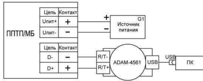
Рисунок 6.5. Схема подключения одного ПТП/МБ к источнику питания G1, преобразователю интерфейса ADAM-4561 и ПК при настройке и измерениях
