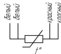
Рисунок 4 – Схема соединения ТСП 9715 (исполнения 04.02, 05.02, 07.02, 12.02-15.02), ТСМ 9715 (исполнения 20.02-23.02)
