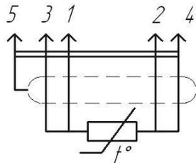
Рисунок 1 – Схема соединения ТСП 9715 (исполнения 00.01, 01.01, 03.01, 08.01-11.01), ТСМ 9715 (исполнения 16.01-19.01)
