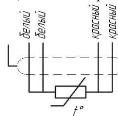
Рисунок 2 – Схема соединения ТСП 9715 (исполнения 04.01, 05.01, 07.01, 12.01-15.01), ТСМ 9715 (исполнения 20.01-23.01)
