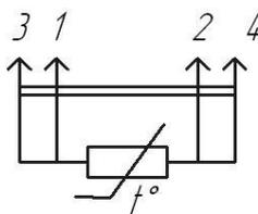
Рисунок 3 – Схема соединения ТСП 9715 (исполнения 00.02, 01.02, 03.02, 08.02-11.02), ТСМ 9715 (исполнения 16.02-19.02)
