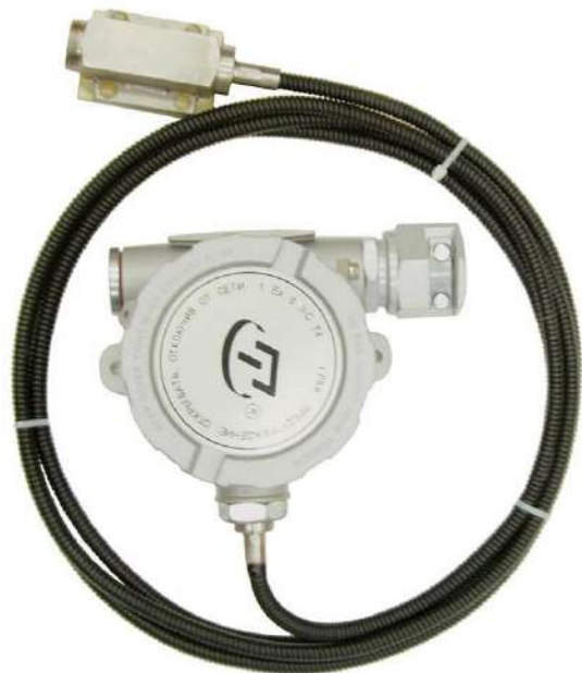
Общий вид ТС с защитным корпусом типа «К2», с головкой типа «Г6», с соединительным кабелем с внешней оболочкой из нержавеющей трубы и металлорукава с полихлорвиниловой изоляцией МРПИ 10
