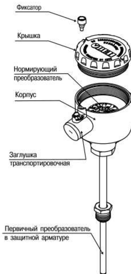
Рисунок 3.1 – Устройство датчика
