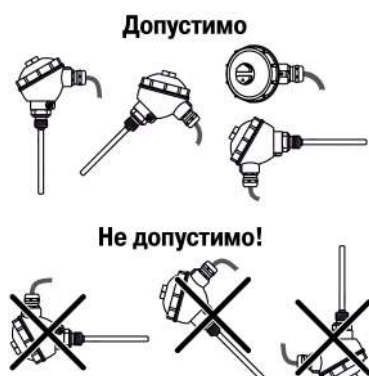
Рисунок 5.2 – Положение при монтаже
