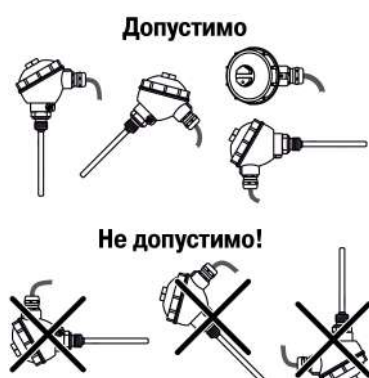
Рисунок 5.2 – Положение при монтаже
