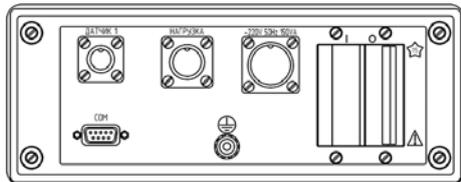
Схема подключения БУ-7-9
