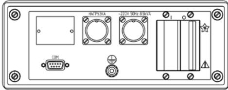
Схема подключения БУ-7-4
