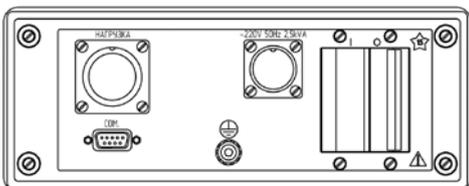
Схема подключения БУ-7-6
