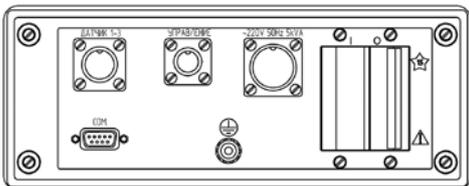
Схема подключения БУ-7-3
