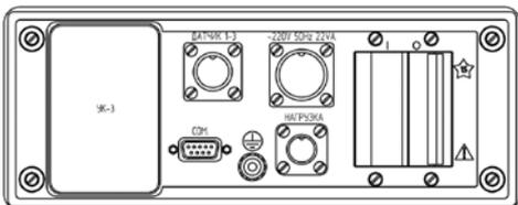
Схема подключения БУ-7-2
